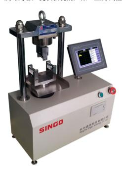
电子压力试验机主要适用于橡胶、塑料板材、管材、异型材,塑料薄膜、电线电缆、防水卷材、金属丝、纸箱等材料的各种物理机械性能测试。不同行业的材质抗压强度不同,因此压力试验机的测量范围也有所不同
